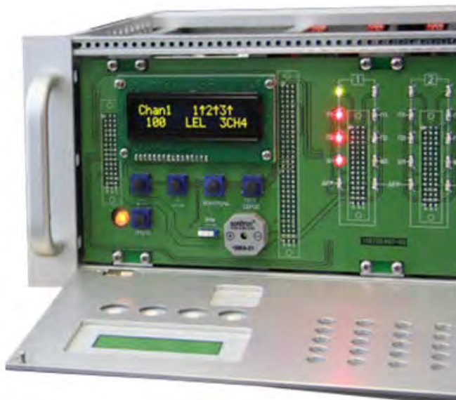
Рис. 4.5 – Индикация «Превышение». Сопровождается звуковой сигнализацией
