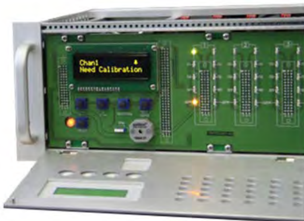
Рис. 4.3 – Индикация «Требуется калибровка». Сопровождается звуковой сигнализацией
