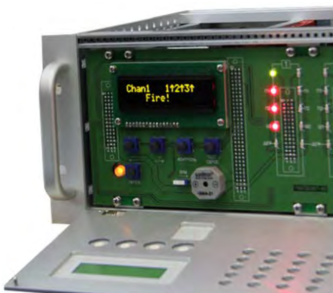
Рис. 3.1 – Индикация пожара, сопровождаемая звуковой сигнализацией.
