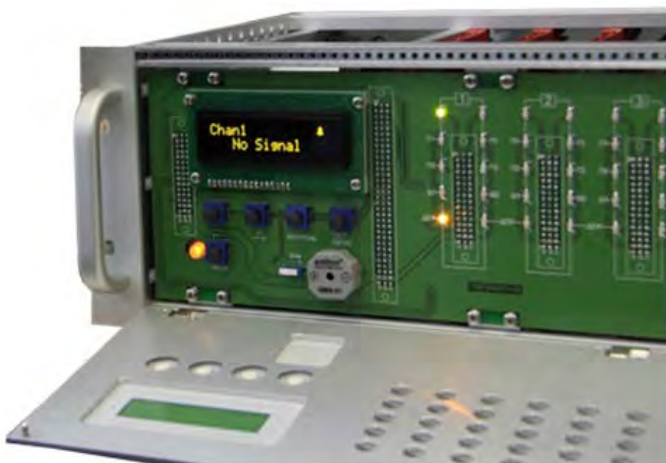
Рис.4.1 – Индикация «Нет Сигнала». Сопровождается звуковой сигнализацией
