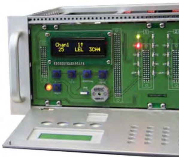
Рис. 4.4 – Измеренные значения концентрации (сопровождается звуковой сигнализацией): 1) Превышение первого порога
