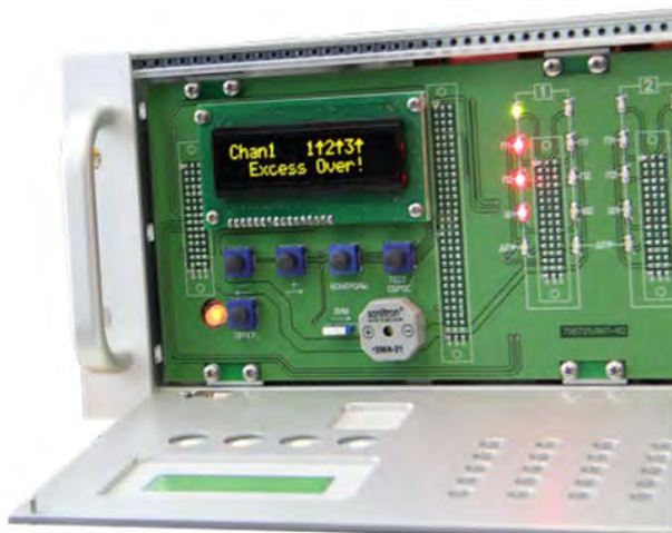
Рис. 4.5 – Индикация «Превышение». Сопровождается звуковой сигнализацией
