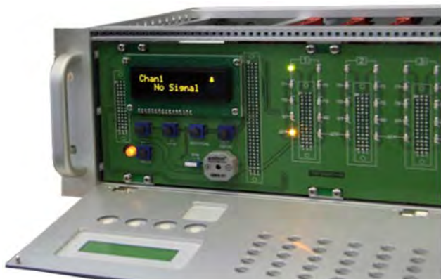
Рис. 3.4 – Индикация УПЭС при потере связи с ИПЭС. Сопровождается звуковым сигналом.
