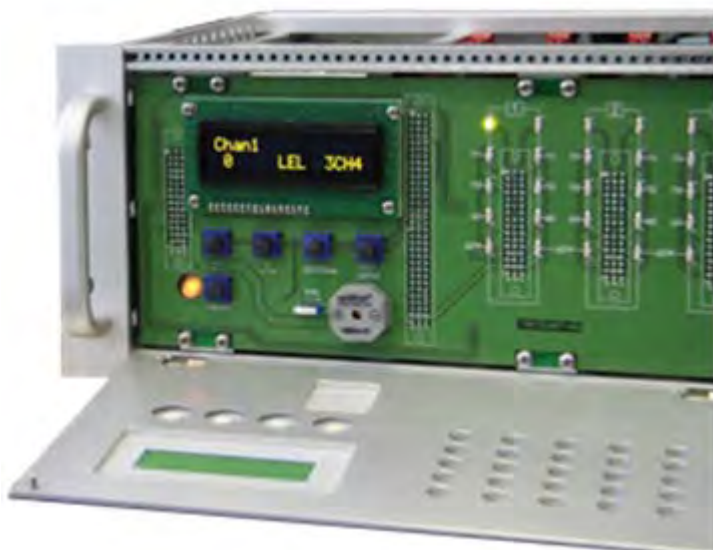
Рис.4 – Дежурный режим работы УПЭС-50А и газоанализатора
