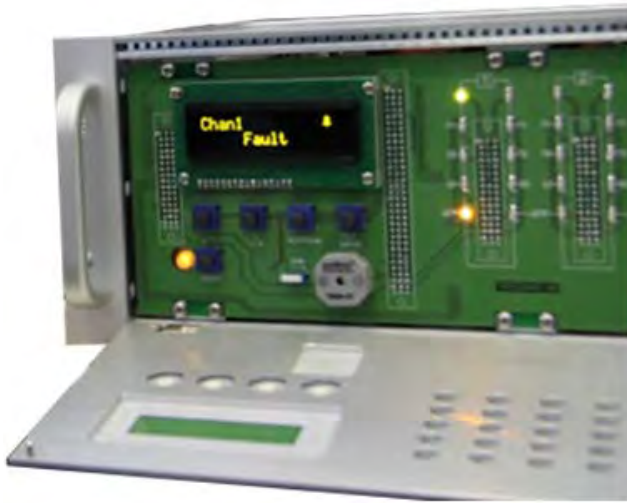
Рис. 3.2 – Неисправность ИПЭС (запыленность), отображение индикации неисправности на УПЭС. Сопровождается звуковой сигнализацией
