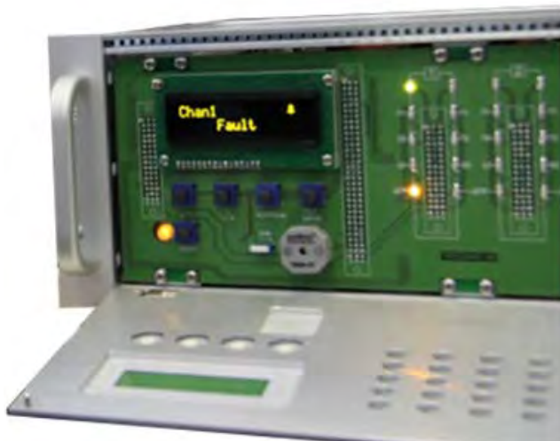
Рис. 4.2 – Индикация «Неисправность». Сопровождается звуковой сигнализацией
