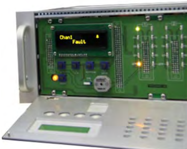
Рис. 3.3 – При поднесении магнитного ключа к ИПЭС, прибор становится неисправным. Отображение индикации на УПЭС сопровождается звуковой сигнализацией.
